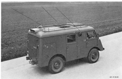
Fig. 1b Kdo. Fahrzeug Mowag, Antennen in Fahrbereitschaft - Voiture de cdmt Mowag, antennes attachées pour la marche
